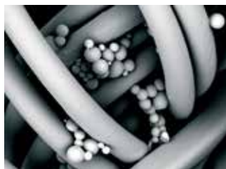
Mikrokapsle Skintex® Active Care na textilních vláknech
