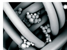
Mikrokapsle Skintex® Active Care na textilních vláknech
